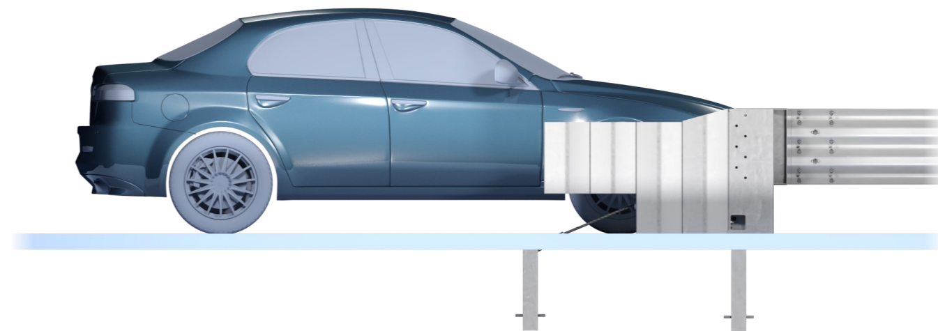
Soluzione per le barriere stradali con nastro 3 onde (MT 5M-900)
