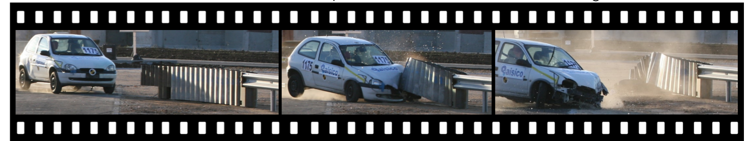
TT 3.3.110 - Frontale, centrale a 15° (test supplementare richiesto da prEN 1317-7)
