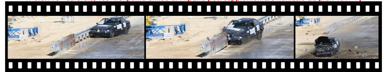
TT 6.3.110 - Laterale, 165° nel punto critico di impatto (test supplementare richiesto da prEN 1317-7)
