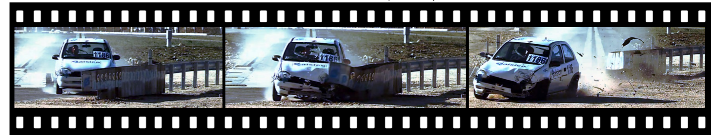
TT 6.3.110 - Laterale, 165° nel punto critico di impatto (test supplementare richiesto da prEN 1317-7)
